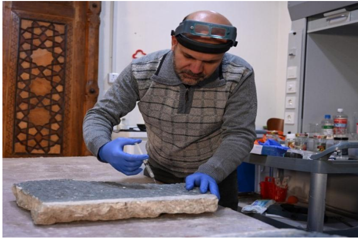
صورة رقم (٣) تقوية اللوح بطريقة الحقن
